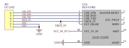
NOTE: THE POWER SUPPLY TO THE MODULE IS 5V, BUT THE MCU IS WOKING UNDER 3.3V, THE ONBOARD LDO WILL REGULATE THE 5V POWER TO 3.3V.
